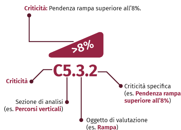
Figura 3 – Schema sinottico della struttura dei codici criticità
